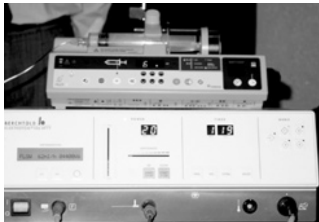
Figura 1. Equipo de radiofrecuencia que en la parte superior tiene la bomba de infusión. En el panel inferior se encuentra el generador y los controles para su manejo.
